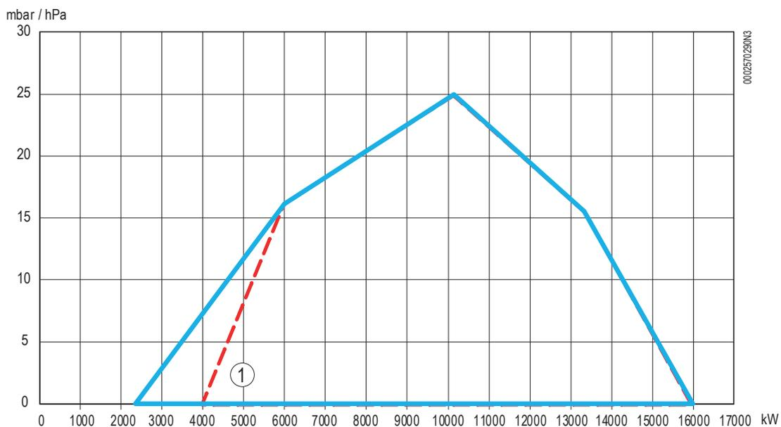
1 Минимальная мощность регулировки при работе на дизельном топливе.
